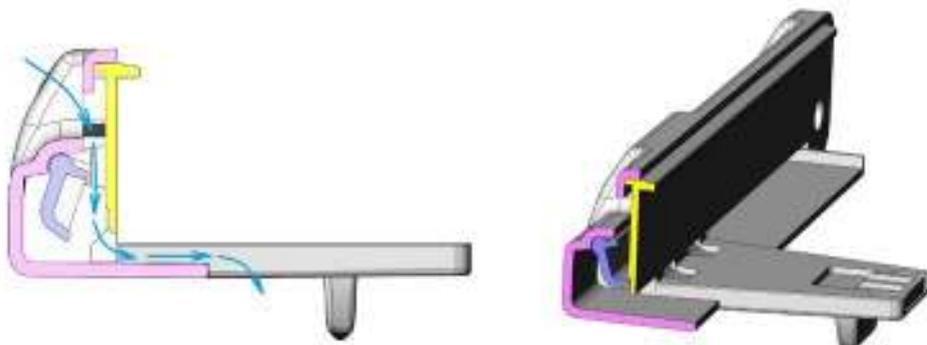
При перемещении ползунка заслонка поворачивается и перекрывает воздушный канал.
